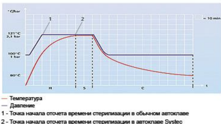
Рисунок 3. График изменения температуры и давления в процессе стерилизации
