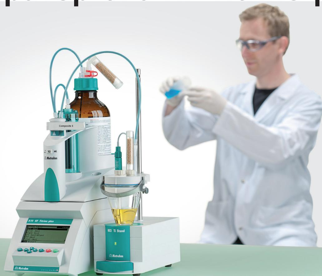
Определяет содержание воды в образце быстро,
