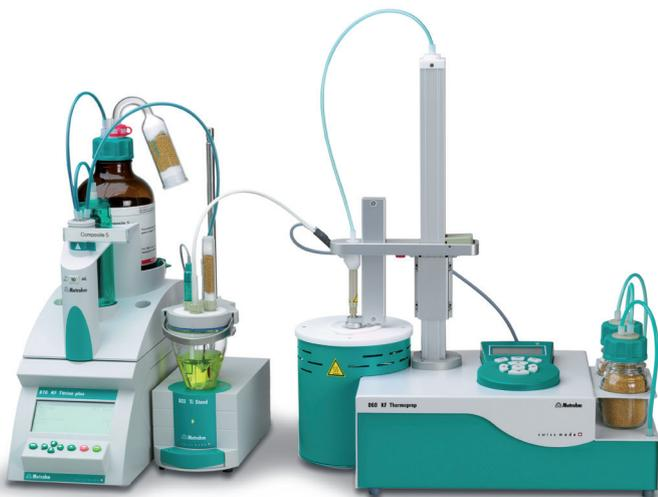
Метод КФ печи для пробоподготовки сложных образцов. На картинке печь 860 KF Thermoprep с ручным вводом образцов.
