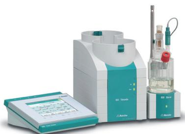
Титраторы 851 и 852 Titrando для определения следовых количеств воды. На картинке 851 Titrando.
